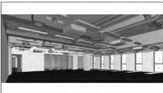
天井非表示による天井裏の確認
