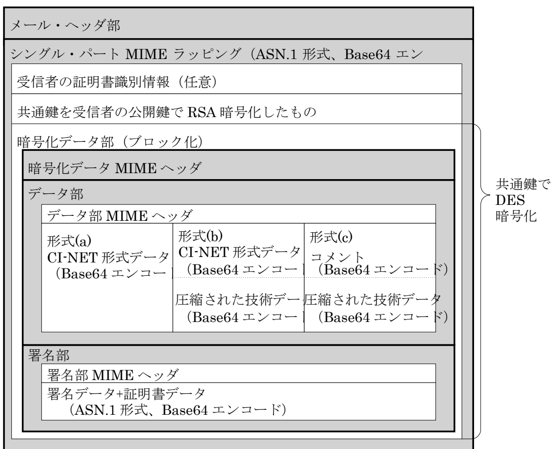
図 A-4 電子メールへのデータ格納構造の概要
