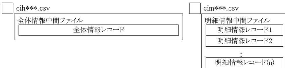
図 B. II.3-2 BCS.CSV 互換中間ファイルの全体情報中間ファイルと明細情報中間ファイルの関係
