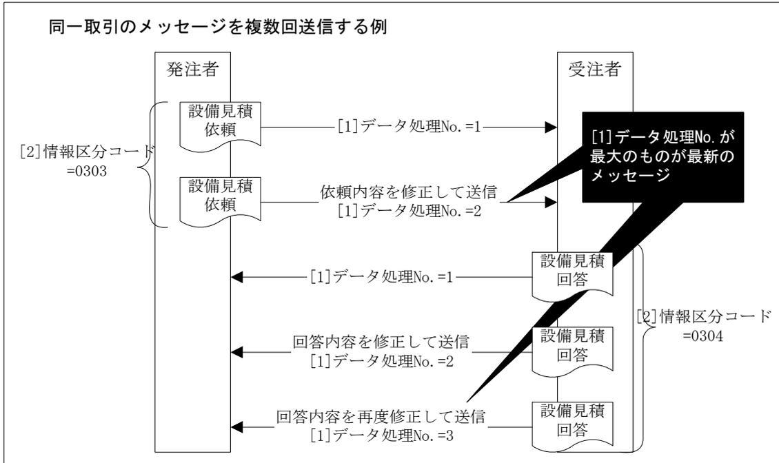
図B.Ⅲ.2-3 [1]データ処理 No.によるメッセージの識別
