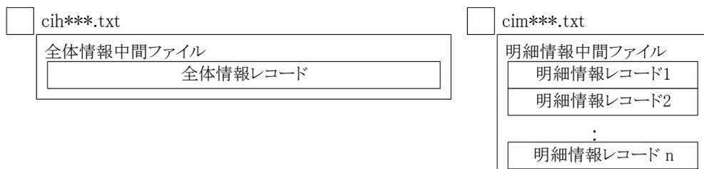
図 B. II.3-3 CI-NET LiteS 互換中間ファイルの全体情報中間ファイルと明細情報中間ファイルの関係
