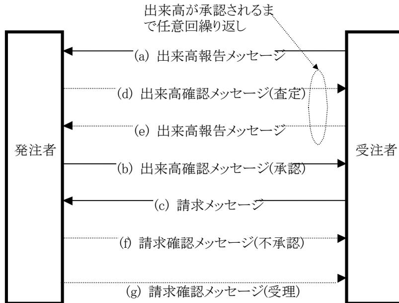
図 B.VII.1-1 出来高、請求業務のデータ交換基本フロー
