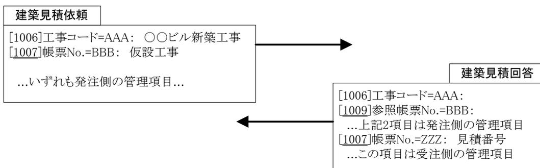
図 B.Ⅱ.2-1 [1007]帳票 No.と[1009]参照帳票 No.による建築見積依頼・回答メッセージの対応
