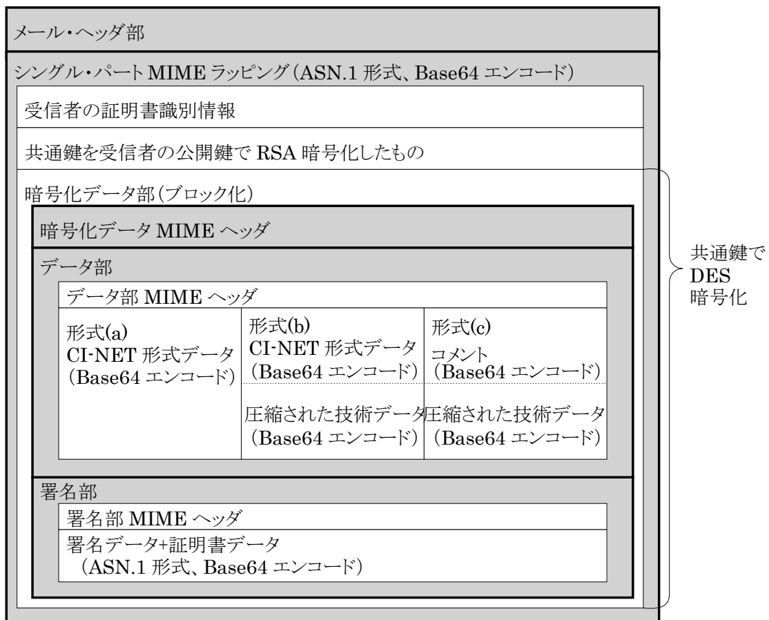
図 A.3-1 電子メールへのデータ格納構造の概要
