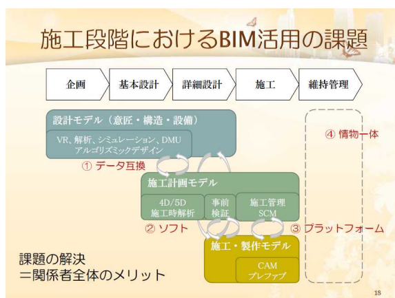
図 4.8 施工段階における BIM 活用の課題 (出典：竹中工務店志手氏講演資料より引用)
