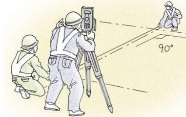
トランシットは位置や角度を測量する機械。レーザーで自動的に計算するなど、高度になっています。
