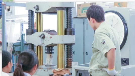
パクトが大きなものにしたいと児玉先生。「例えば、コンクリートに圧をかける材料実験。『砕けるまでにはどのくらい力が必要だと思う?』と在校生から質問を投げかけると、『1000トン!』など、中学生はそれぞれに予想を口にします。足で踏みつけるなどコンクリートの粉碎に挑戦してもらいますが、もちろん人間の力では砕けません。そこで機械で徐々に力を加え、砕いて見せます。また、鉄筋の引張試験も、毎回取り入れる体験メニューです。鉄筋を上下に引っ張り、その変化を観察します。最終的にはけたたましい音とともに鉄筋が引きちぎれますが、そのかけらに触れて硬さや質感を実感してもらっています。入学後、『1日入学で、印象に残っているものは何?』と尋ねると、この実験をあげる生徒が多いです」(児玉先生)
