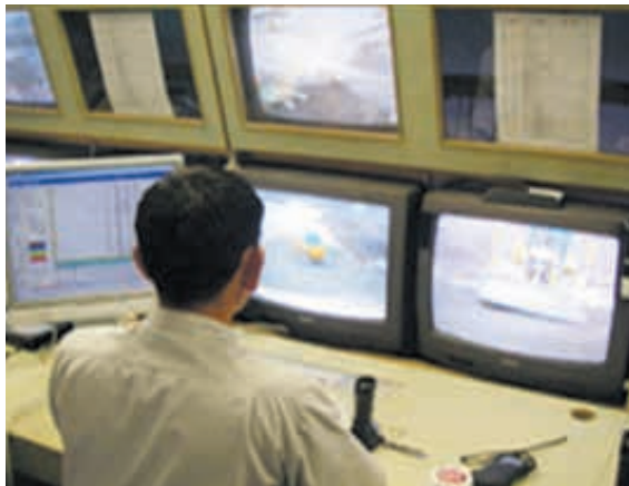
雲仙普賢岳での無人化施工風景(上)と遠隔操作による重機操作風景 バックホウ
